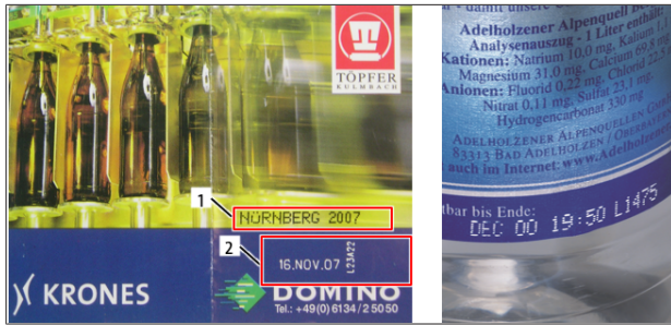
图 2: 喷墨打码和激光打码的示例
