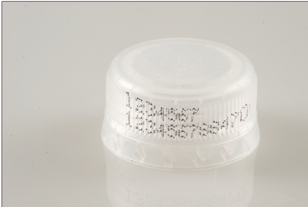
图 7: 在凹槽上进行喷墨打码
