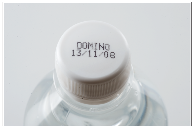
图 9: 在封盖上进行喷墨打码
