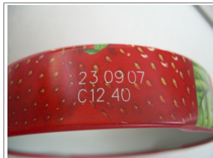
图 12: 金属封盖上的激光打码
