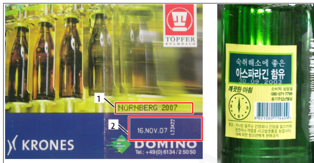
图 1: 喷墨打码和激光打码的示例
