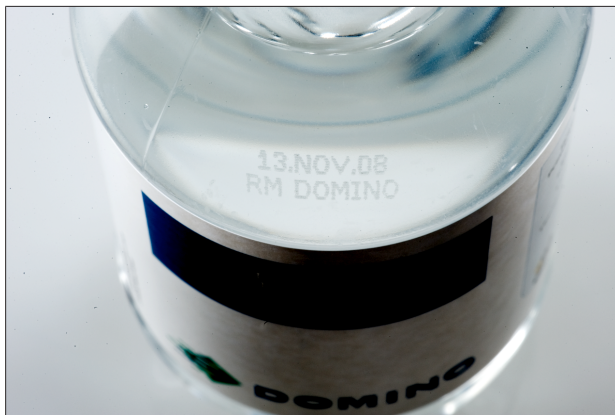
图 5: 在瓶子上进行划线激光打码
