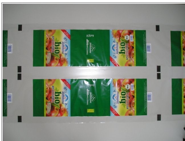
图 13: 薄膜打码的示例 (条形码)
