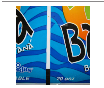
Fig. 91: Mais do que uma cor na zona de detecção antes e depois da marca de corte e contraste de cor não suficiente
