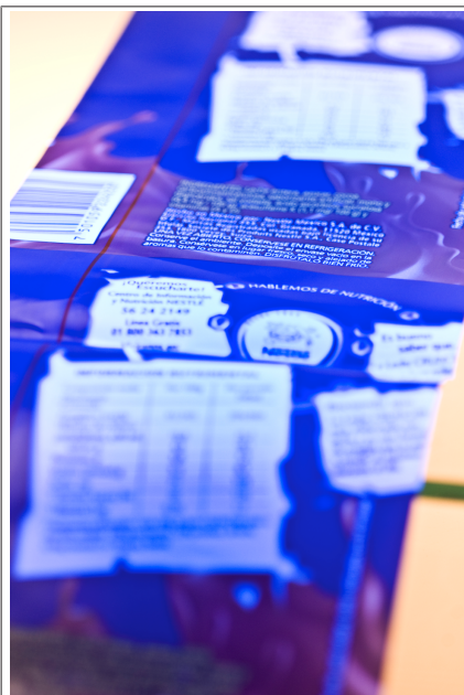
Fig. 119: Marca de corte de luminescência NÃO legível
