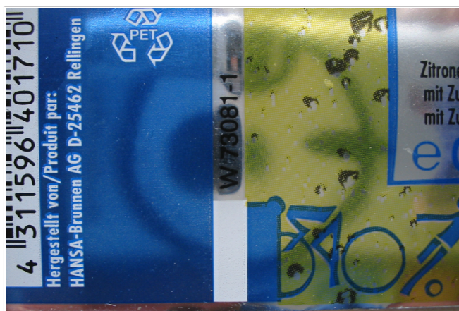
Fig. 83: Exemplo para uma marca de corte na borda inferior do rótulo
