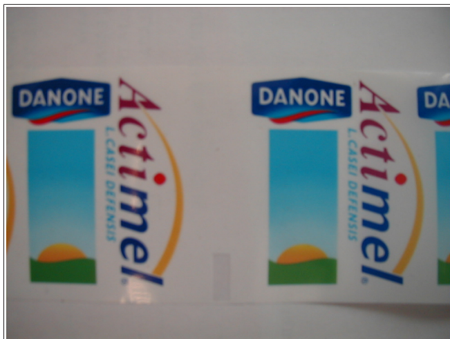
Fig. 89: Exemplo para um rótulo transparente com marca de corte transparente não impressa
