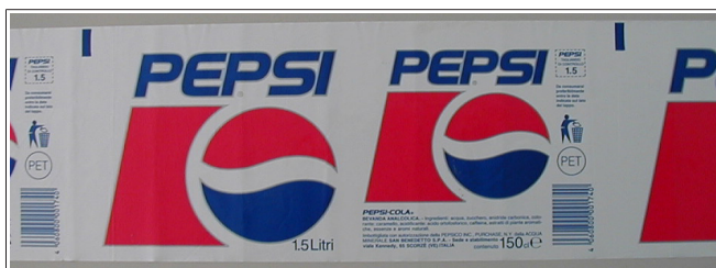
Fig. 84: Exemplo para uma marca de corte na borda superior do rótulo
