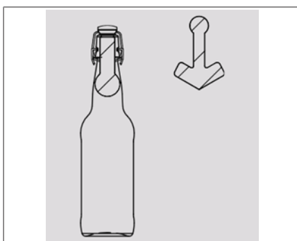
Fig. 27: Rótulo para fecho de estribo: envolve o fecho em forma de estribo
