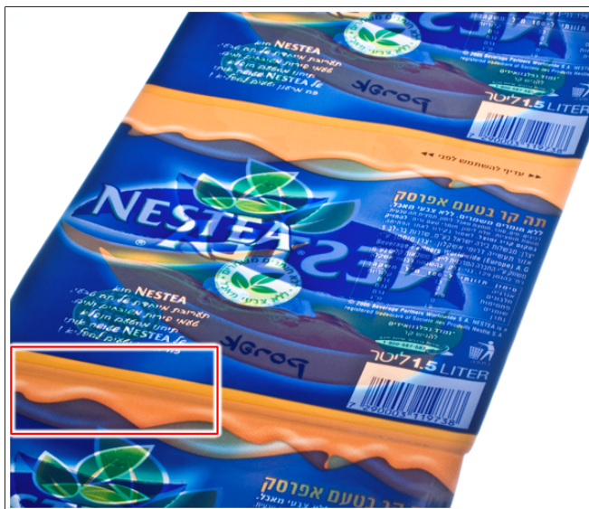
Fig. 116: Marca de corte de luminescência legível
