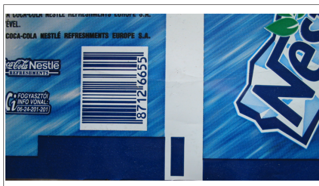
Fig. 94: Mais do que uma cor na zona de detecção antes e depois da marca de corte
