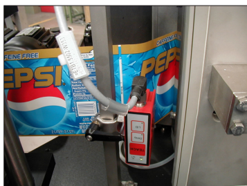
Fig. 73: Exploração por sensor de uma marca de corte
