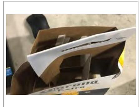
Fig. 90: Déformation par découpe
