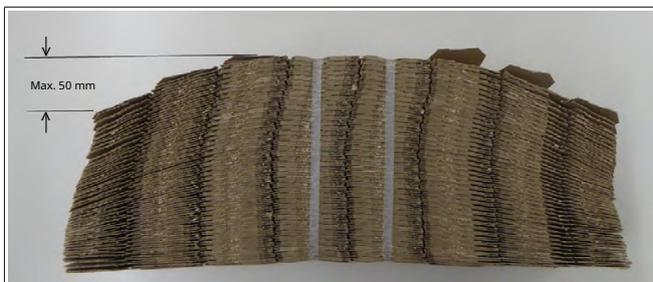
Une déformation de 50 mm maximum est tolérée sur la hauteur d'empilage totale.
