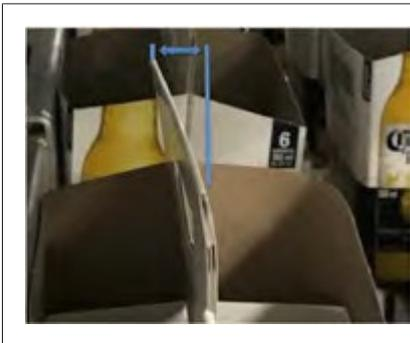
Fig. 88: Déformation d'une poignée
