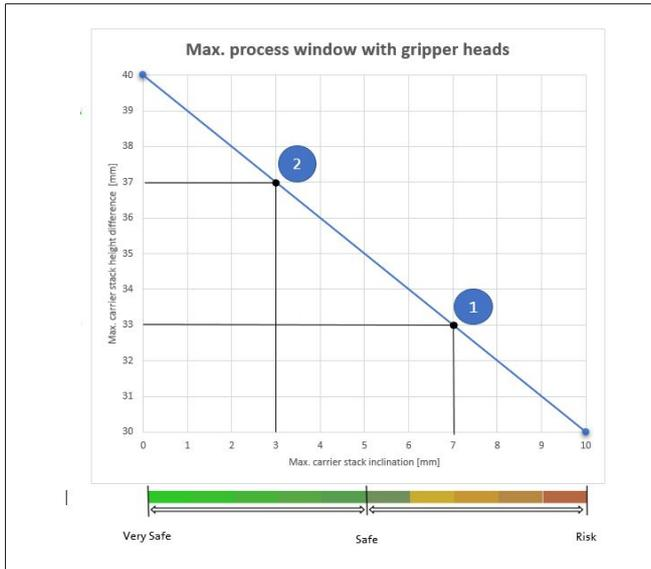
Fig. 139: Plages de différence de hauteur d'empilage admissible en fonction de l'inclinaison
