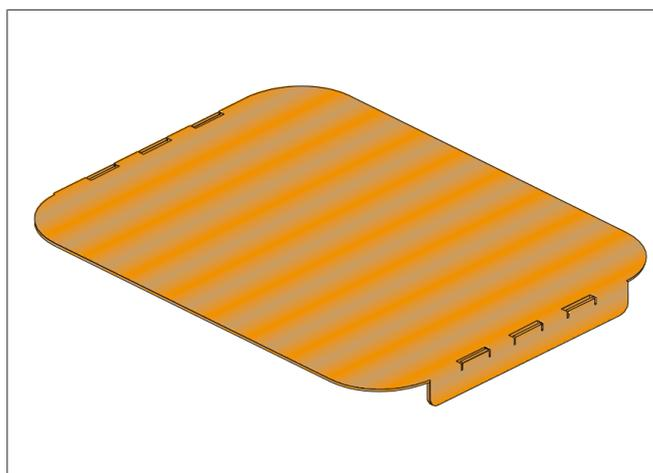
Fig. 83: Falda a U (fustellato piegato)
