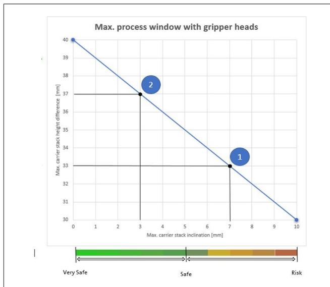
Fig. 139: Range della differenza di altezza delle pile consentita in base all'inclinazione
