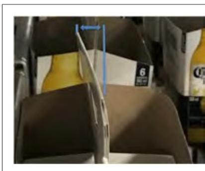
Fig. 88: Deformazione maniglia
