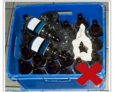
图 48: 箱子里有异物和方向错误的玻璃瓶
