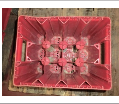
图 42: 略微凹陷的箱壁
