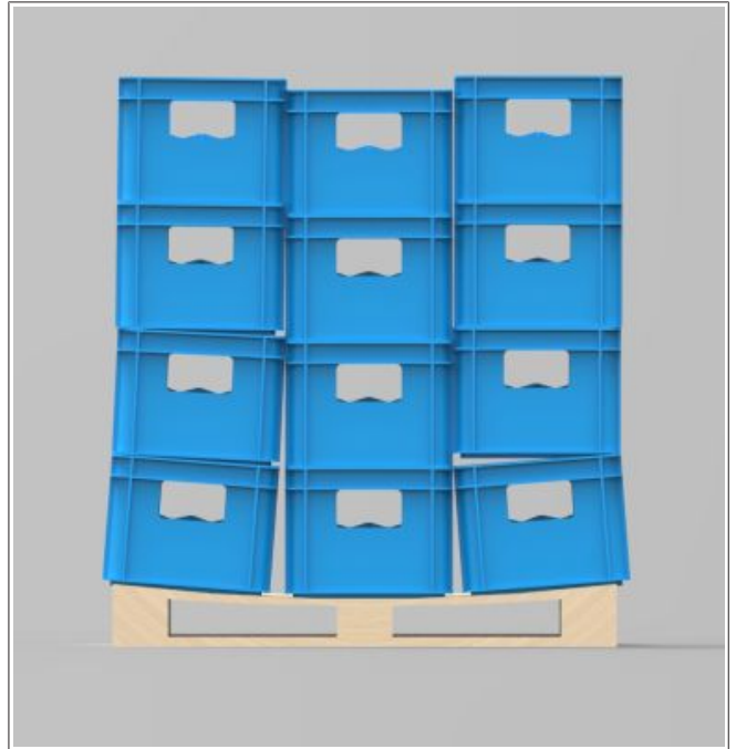
图 73: 托盘下降后：关键条件是，箱子仍然卡入到位
