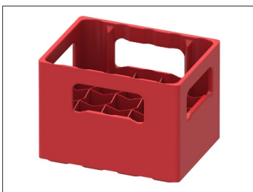
图 30: 饮料箱的最佳外部几何形状
