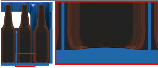
图 31: 隔板和瓶底的曲率
