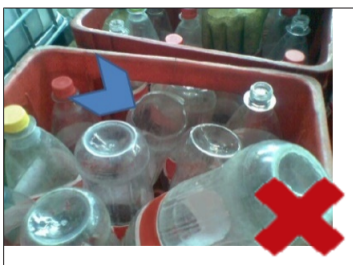
图 68: 装有方向不正确容器的饮料箱
