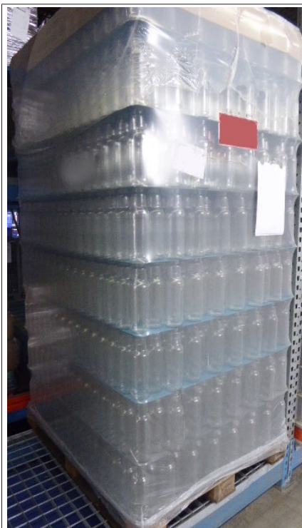
Fig. 6: Pila de envases nuevos perfectamente alineada con placas intercaladas de plástico
