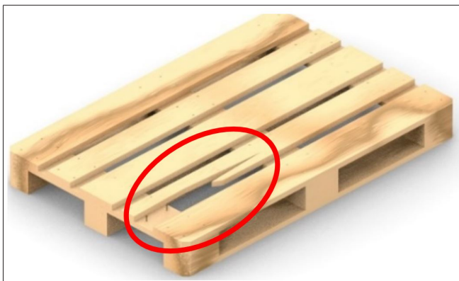
Fig. 34: Cuando alguna tabla esté tan astillada que se vea más de un tornillo o un clavo.
