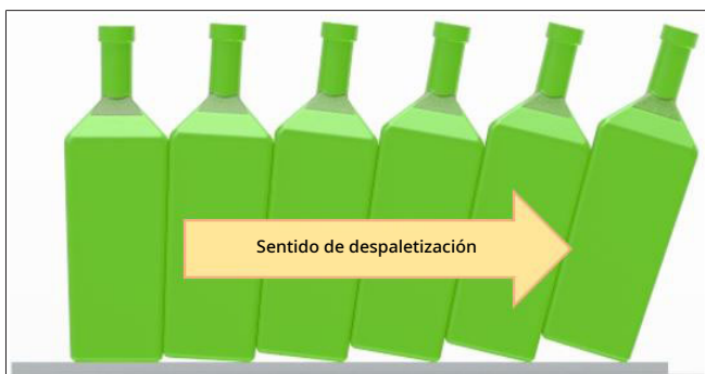
Fig. 73: Problema de vuelco durante la despaletización de envases cónicos
