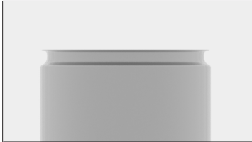
Fig. 81: Vista lateral de una lata con el borde todavía sin rebordar
