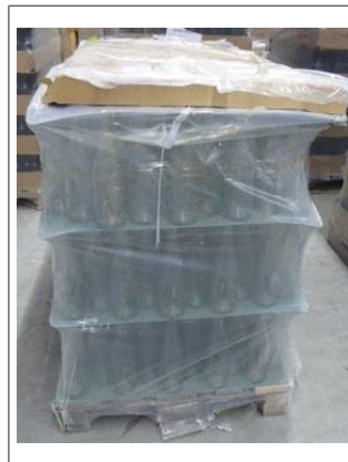
Fig. 11: Pila de envases nuevos con bandeja invertida ligeramente desplazada (se requiere su retirada manual) y placas intercaladas dobladas
