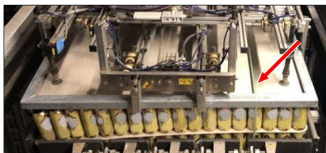
Fig. 57: Incidente al levantar el bastidor estabilizador. Motivo: Fleje sin quitar en la pila de envases nuevos
