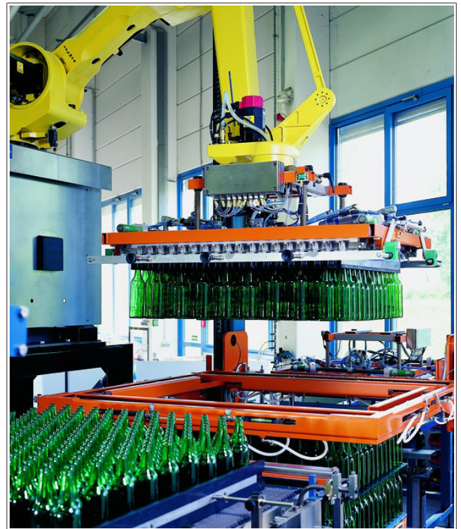
Fig. 4: Elevación totalmente automática con cabezal con listones de agarre o cabezal de agarre con tubos inflables
