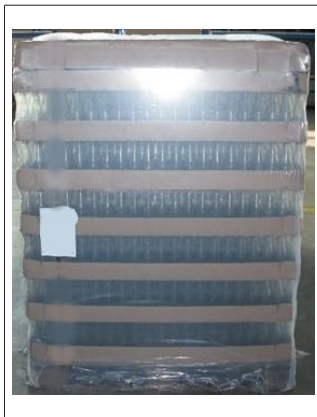
Fig. 9: Pila de envases nuevos con las esquinas de las bandejas invertidas metidas para adentro
