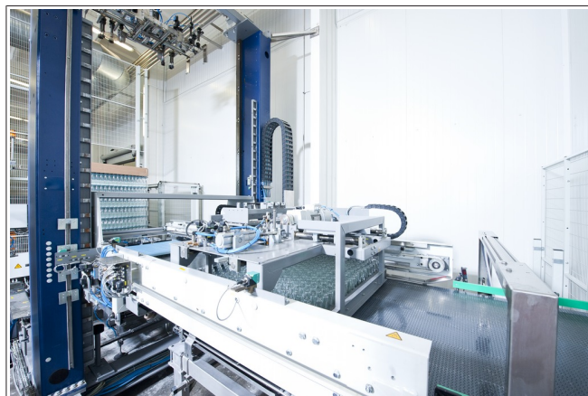
Fig. 2: Despaletizadora horizontal totalmente automática durante la despaletización
