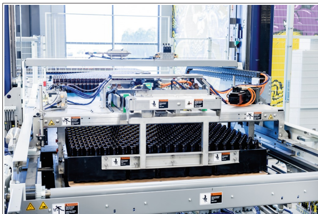
Fig. 1: Despaletizadora horizontal totalmente automática con envases en empaquetamiento compacto
