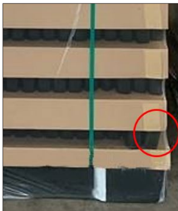
Fig. 53: Pila de vidrio nuevo con bandeja invertida demasiado grande y botellas movidas
