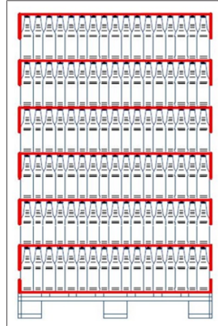
Fig. 51: Sistema de bandejas invertidas con una bandeja a modo de placa inferior; apto desde el punto de vista funcional para las despaletizadoras verticales
