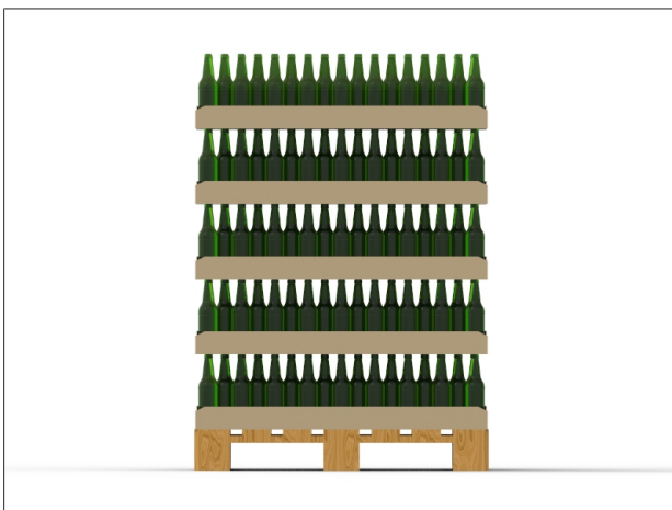
Fig. 25: Pila vertical con gran precisión de apilado
