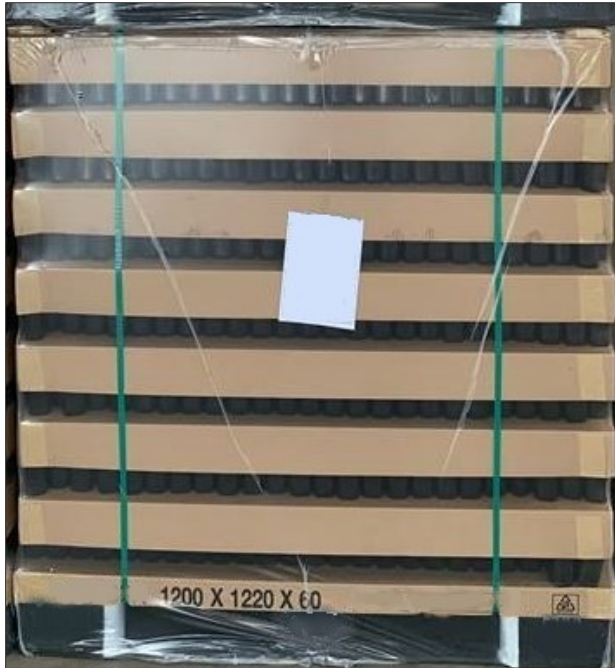
Fig. 56: Flejes verdes con bastidor estabilizador sobre una pila de vidrio nuevo
