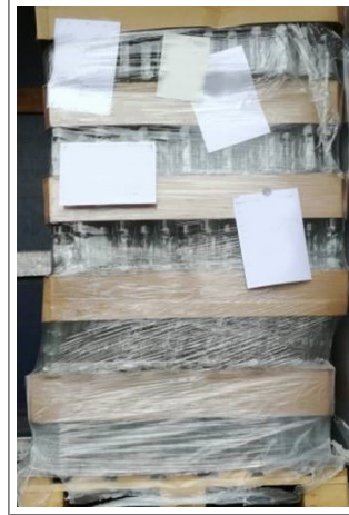
Fig. 15: Pila de envases nuevos con capas de envases muy torcidas
