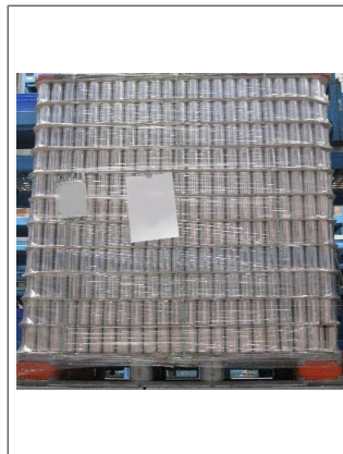
Fig. 10: Pila de latas nuevas con placas intercaladas ligeramente dobladas por el borde
