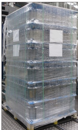
Fig. 40: Pila de vidrio nuevo envuelta en film extensible
