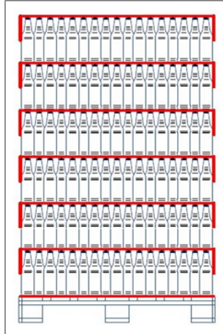
Fig. 50: Sistema de bandejas invertidas con una placa inferior plana; apto desde el punto de vista funcional para las despaletizadoras horizontales
