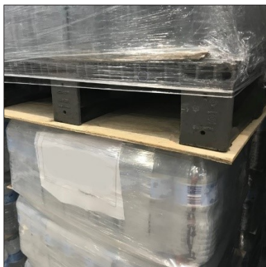
Fig. 55: Pila de envases nuevos con placa de distribución de la carga
