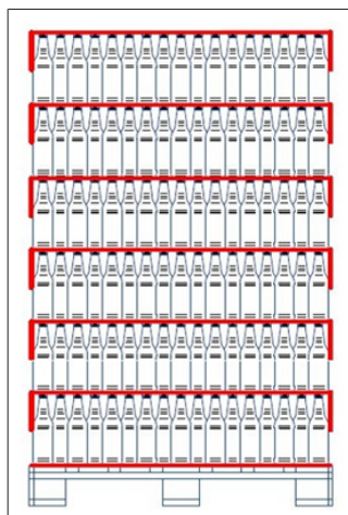
Fig. 50: Sistema di coperchi di protezione con falda del fondo piana; dal punto di vista funzionale adatto per sollevatori
