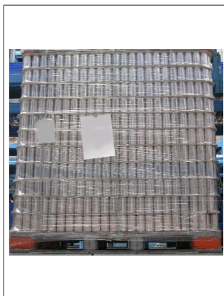
Fig. 10: Pila di lattine nuove con interfalde leggermente piegate nella zona del bordo
