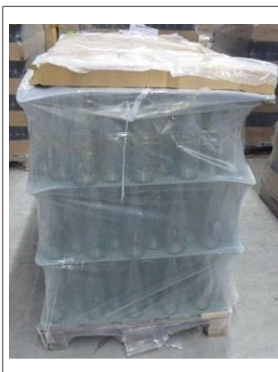
Fig. 11: Pila di recipienti nuovi con coperchi di protezione leggermente spostati (necessario prelievo a mano) e interfalde piegate
