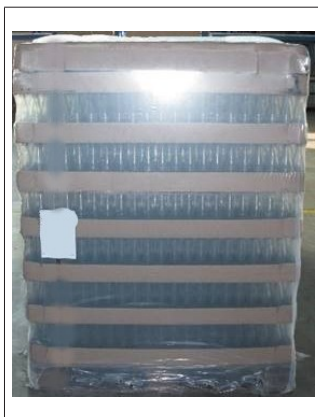
Fig. 9: Pila di recipienti nuovi con angoli dei coperchi di protezione ammaccati
