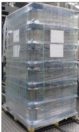
Fig. 40: Pila di bottiglie di vetro nuove imballata in film estensibile
