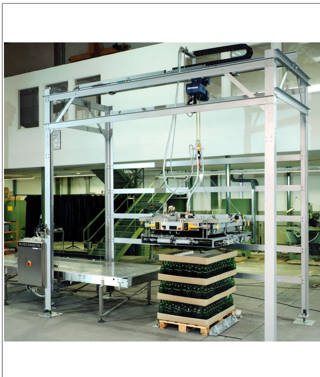
Fig. 3: Sollevatore a portale semiautomatico con pinza a barre comandata in modo manuale
