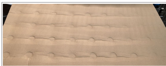
Fig. 21: Profonde impronte di recipienti sul lato inferiore dell'interfaldia, che rendono difficile la rimozione, come esempio di "effetto Lego"
