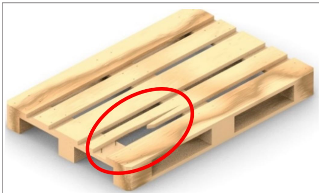
Fig. 34: Se una tavola del piano inferiore o di copertura è scheggiata in modo tale da lasciare scoperto più di un chiodo o una vite (gambo)
