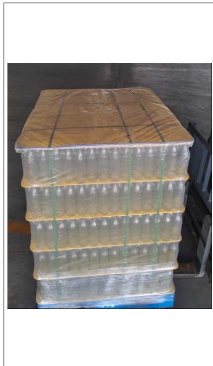
Fig. 8: Pila di recipienti nuovi orientata in modo ottimale con nastri di reggiatura
