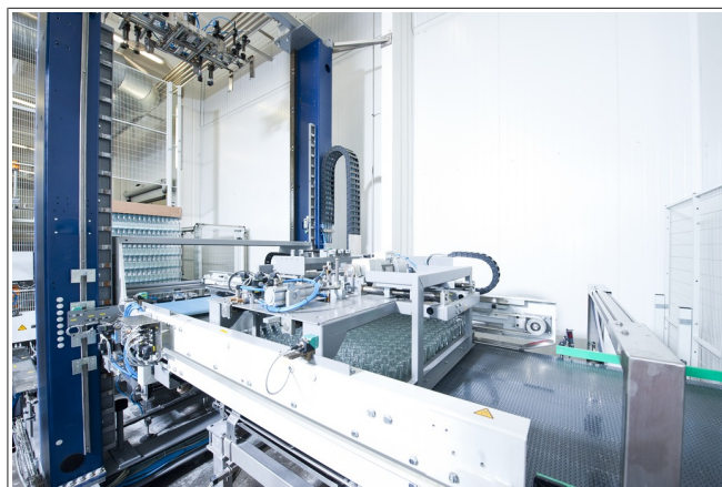
Fig. 2: Depallettizzatore a spinta completamente automatico durante il processo di depallettizzazione a spinta
