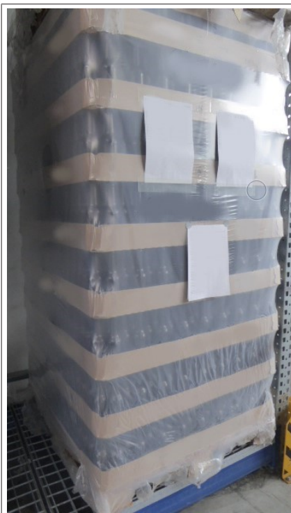
Fig. 7: Pila di recipienti nuovi orientata in modo ottimale con fondi di protezione
