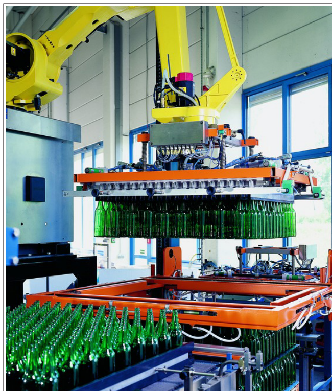
Fig. 4: Sollevamento completamente automatico con pinze a barre o a tubi
