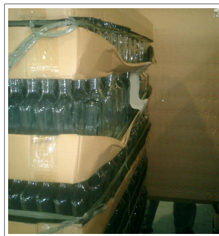
Fig. 19: Pila di recipienti nuovi con fondi di protezione molto deformati e recipienti spostati
