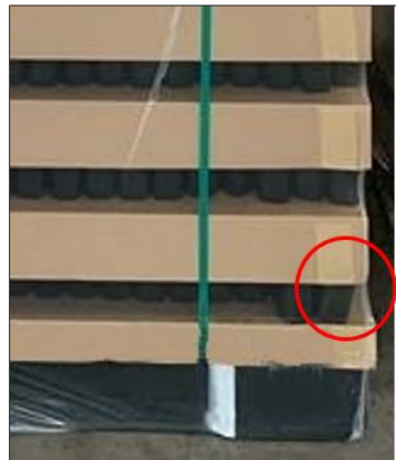
Fig. 53: Pile di recipienti di vetro nuovi con coperchio di protezione troppo grande e bottiglie spostate
