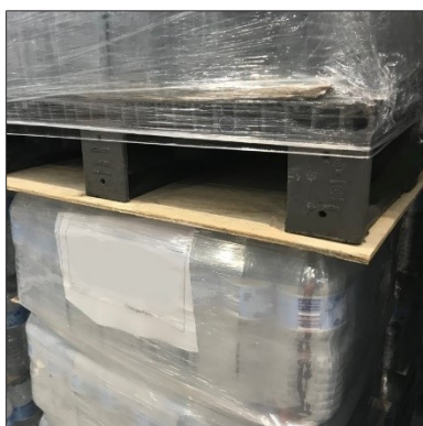
Fig. 55: Pila di recipienti nuovi con piastra di distribuzione del carico
