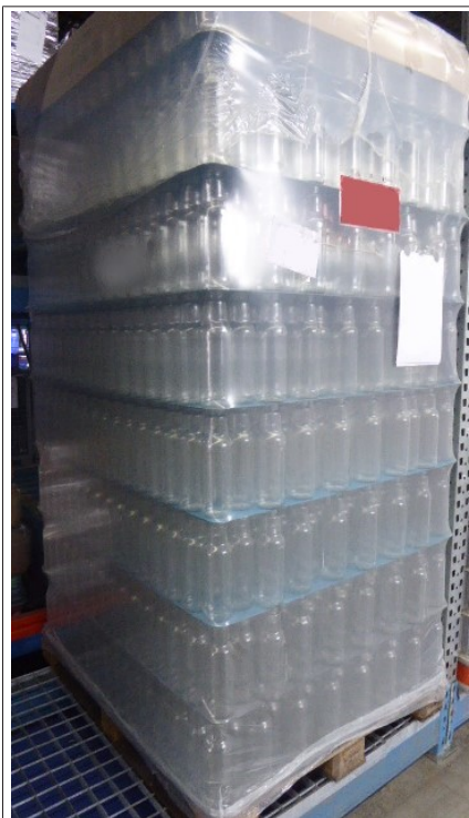
Fig. 6: Pila di recipienti nuovi orientata in modo ottimale con interfalde in plastica
