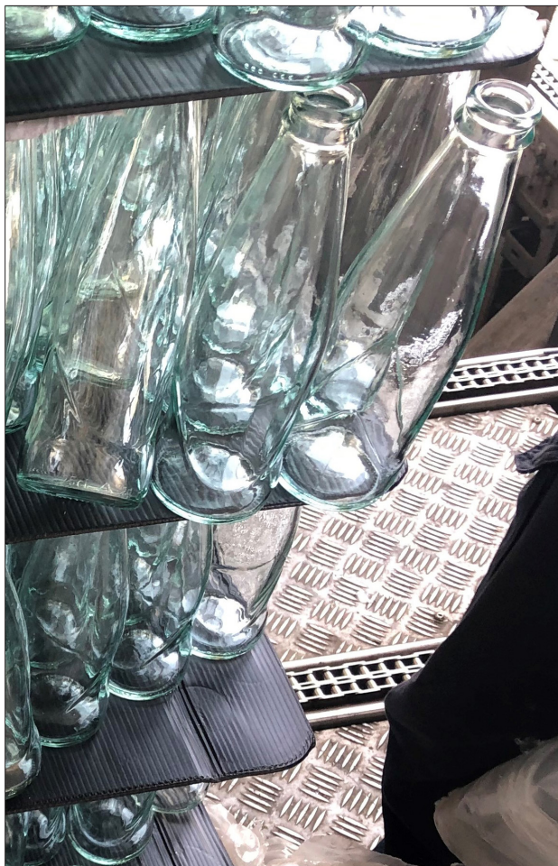
Fig. 44: Recipienti sugli angoli caduti dopo la rimozione del film
