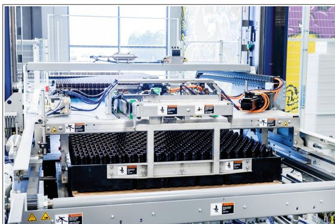
Fig. 1: Desbulk totalmente automático com recipientes em formação tipo empacotamento de esferas
