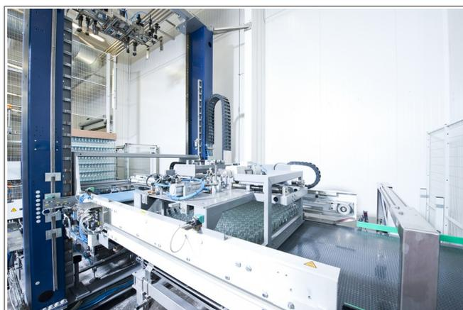
Fig. 2: Desbulk totalmente automático durante o processo de despaletização
