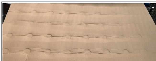
Fig. 21: Fortes marcas dos recipientes no lado inferior da camada intercalar que dificultam a despaletização, como exemplo para o "Efeito Lego"
