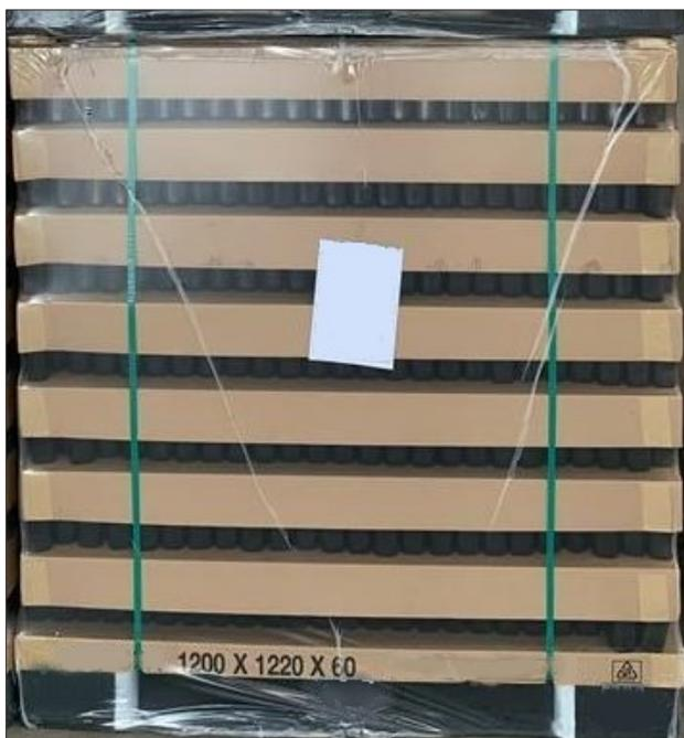
Fig. 56: Bandas de cintagem verdes com moldura de cobertura em uma pilha de vidro novo
