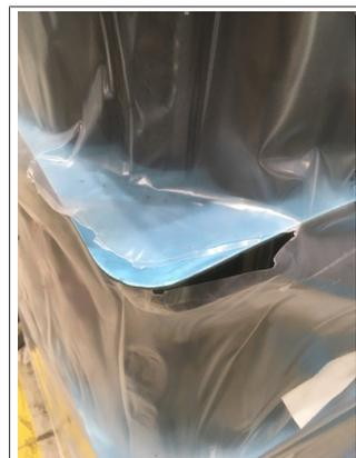
*Fig. 12:* Pilha de recipientes novos com película de embalagem rasgada
