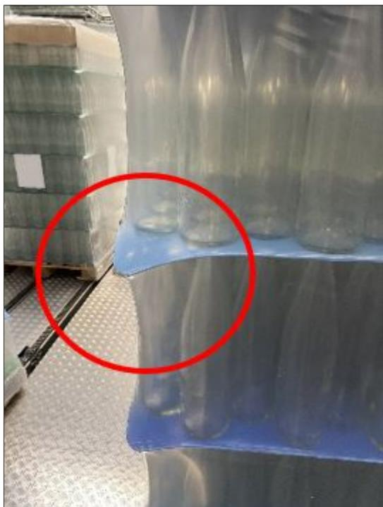
Fig. 41: Camada intercalar inclinada para baixo
