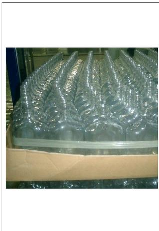
Fig. 13: Pilha de recipientes novos com filas de recipientes deslocadas
