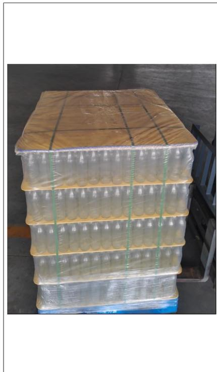
*Fig. 8:* Pilha de recipientes novos perfeitamente alinhada com bandas de cintagem
