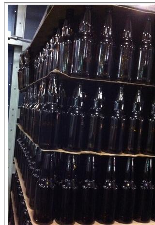
Fig. 16: Pilha de recipientes novos com fila de recipientes caída na camada superior
