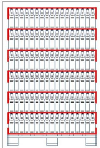
*Fig. 51:* Sistema de bandejas invertidas com uma bandeja de fundo como camada inferior; funcionalmente bom para dispositivo removedor
