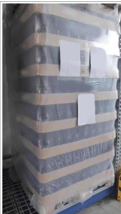
*Fig. 7:* Pilha de recipientes novos perfeitamente alinhada com bandejas de fundo
