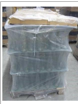
*Fig. 11:* Pilha de recipientes novos com bandeja invertida ligeiramente deslocada (necessária remoção manual) e camadas intercalares dobradas
