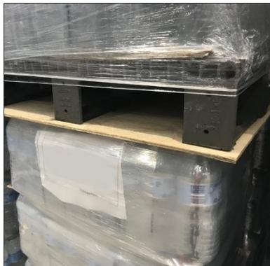
Fig. 55: Pilha de recipientes novos com placa de distribuição da carga
