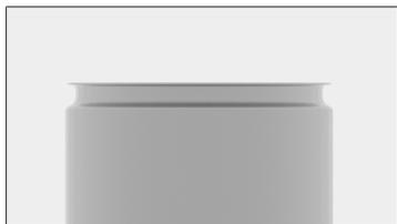
*Fig. 81:* Vista lateral de uma lata com borda rebordada ainda não dobrada
