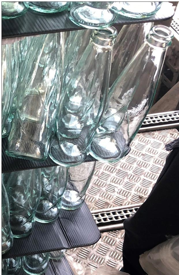
Fig. 44: Recipientes de canto caídos após a remoção da folha
