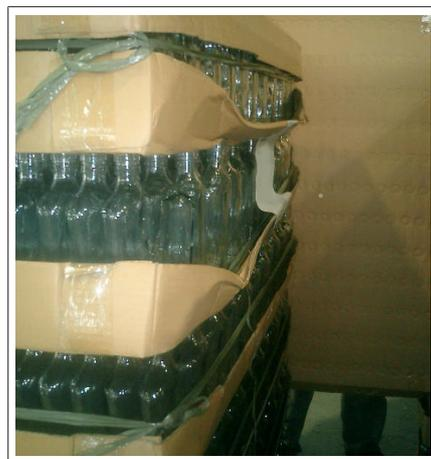
Fig. 19: Pilha de recipientes novos com bandejas de fundo muito deformadas e recipientes deslocados
