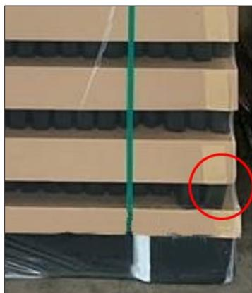
*Fig. 53:* Pilha de vidro novo com bandeja invertida demasiado grande e garrafas deslocadas
