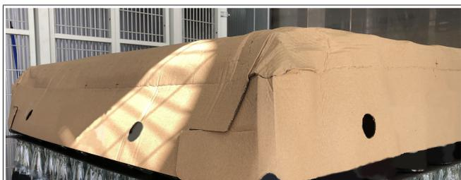
Fig. 20: Bandeja invertida deformada
