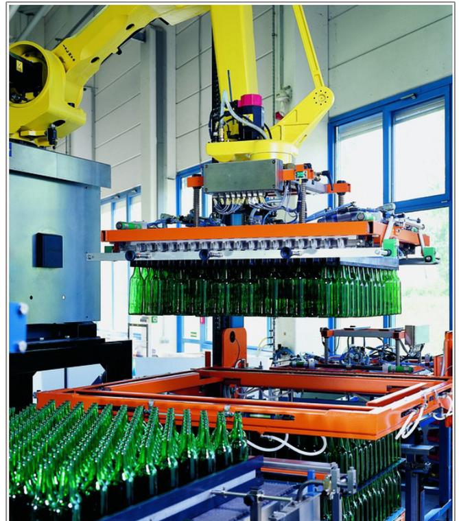
*Fig. 4:* Elevação totalmente automática com garras de réguas ou de tubos
