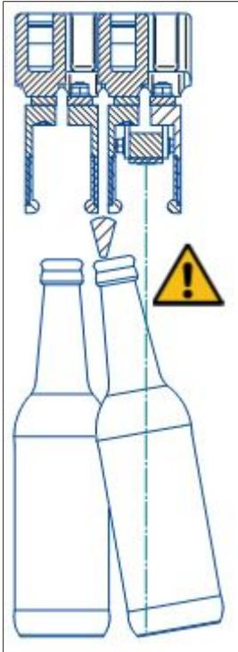
*Fig. 5: Colisão - A inclinação de uma garrafa impede a entrada da pré-centragem do interstício*
