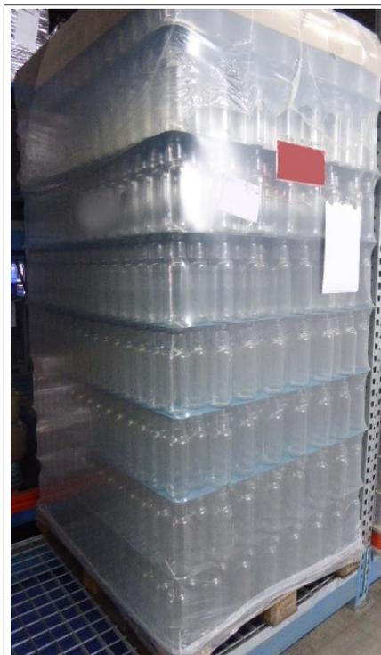
*Fig. 6:* Pilha de recipientes novos perfeitamente alinhada com camadas intercalares de plástico
