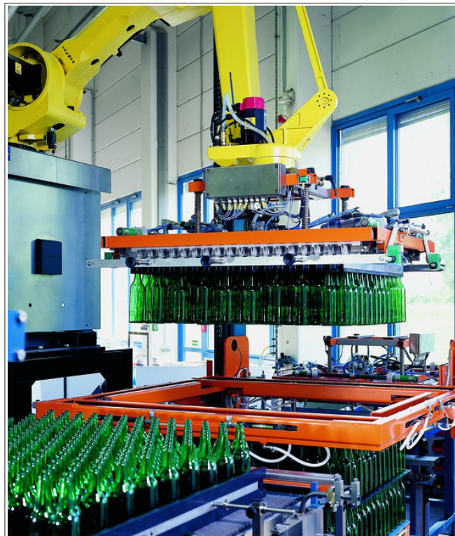
图4: 使用条形夹持器或软管式夹持器进行全自动提取
