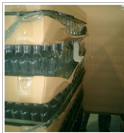
图 19: 翻边底板严重变形且容器明显滑动的新容器堆垛
