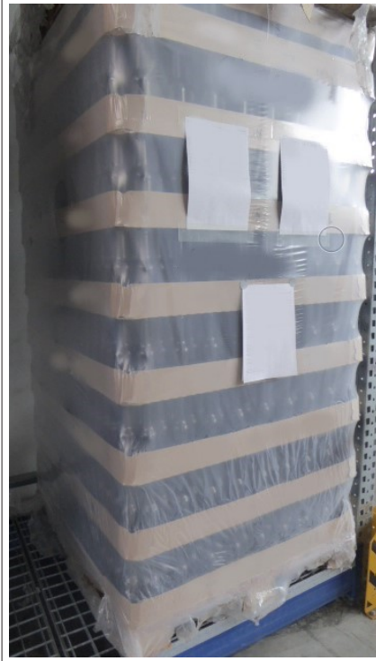
图 7: 使用翻边底板的笔直新容器堆垛
