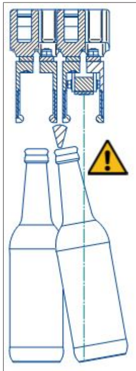
图5: 碰撞 - 瓶子倾斜会阻止间隙 预对中装置伸入
