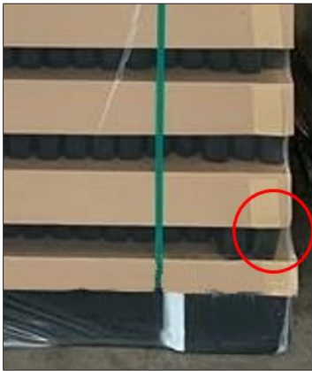
图 53: 套口盖板过大而导致容器滑动的新玻璃瓶堆垛
