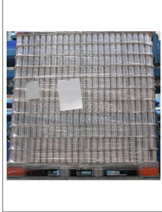
图 10: 边缘区域内的中间垫板稍微被折弯的新易拉罐堆垛
