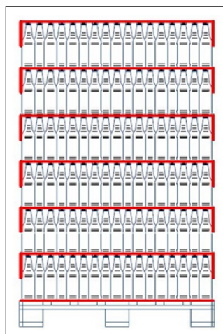
图 50: 带有扁平的底部垫板的套口盖板系统；便于推出器进行处理
