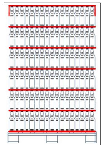
图 52: 没有或只有一个套口盖板的中间垫板系统；便于推出器进行处理
