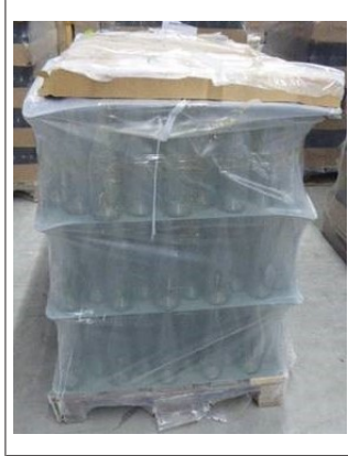
图 11: 套口盖板略微偏移（需要手动移除）且中间垫板被折弯的新容器堆垛
