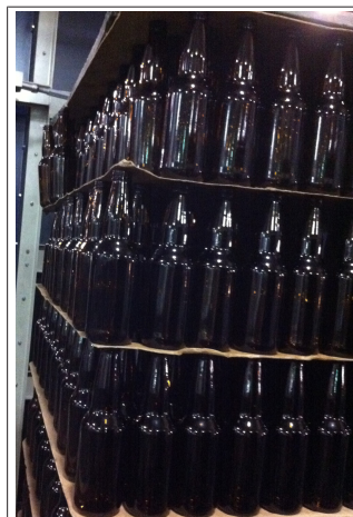
图 16: 上方垛层中有容器列掉落的新容器堆垛
